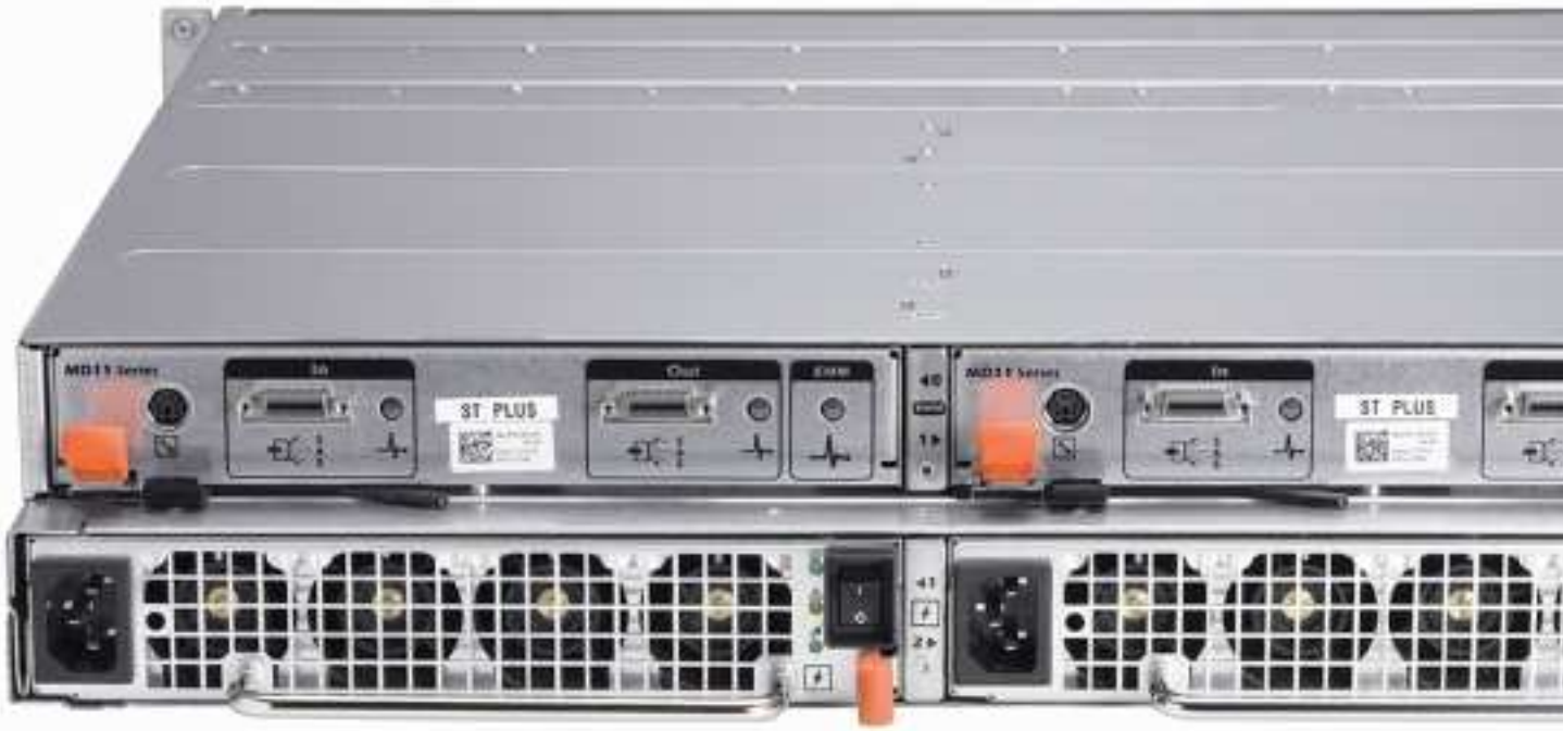
Рис 5. Дисковая полка Dell PowerVault MD1120, с двумя установленными модулями EMM и блоками вентиляторов и питания, вид сзади.
